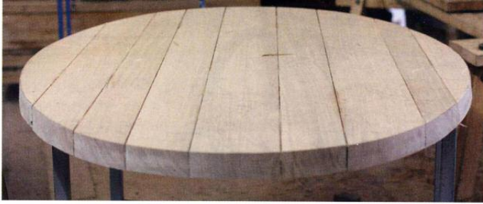
Abb. 9: Die Platte wird später ein gewölbter Fassboden, jede Daube braucht dafür einen individuellen Zuschnitt
