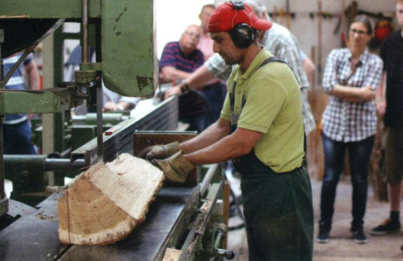
Abb. 4: Aufsagen der Dauben
