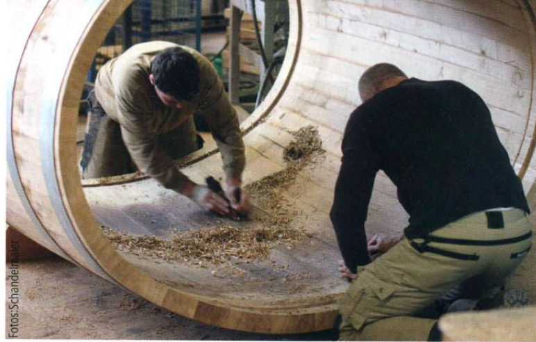
Abb. 6: Viel Handarbeit – Küfer beim Aushobeln eines Fasses
