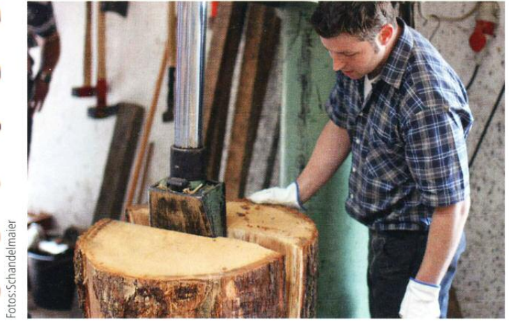
Abb. 3: Spalten des Stammes beim Daubenhauer
