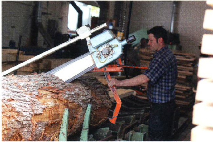
Abb. 2: Der Stamm wird vom Daubenhauer geschnitten
