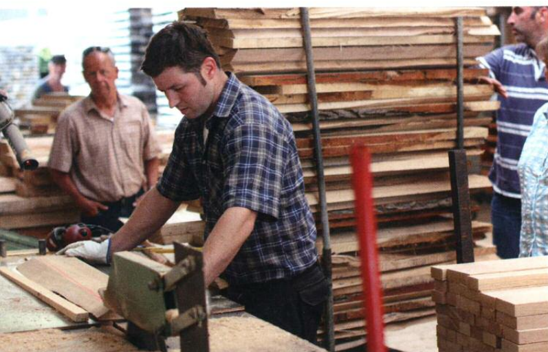
Abb. 5: Zuschnitt der Dauben
